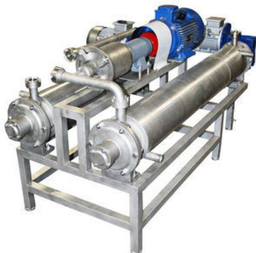
Маслообразователь предназначен для производства сливочного масла методом преобразования высокожирных сливок.
