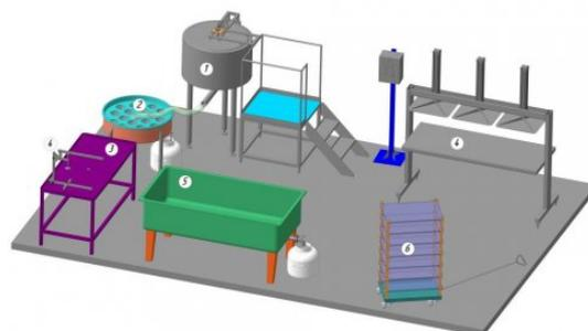
*Ёмкость для варки сыра* выполнена из нержавеющей стали. Она предназначена для термической обработки компонентов будущего продукта. Технологический процесс зависит от сорта сыра – возможен нагрев молока, его последующее охлаждение, добавление ферментов, варка.
