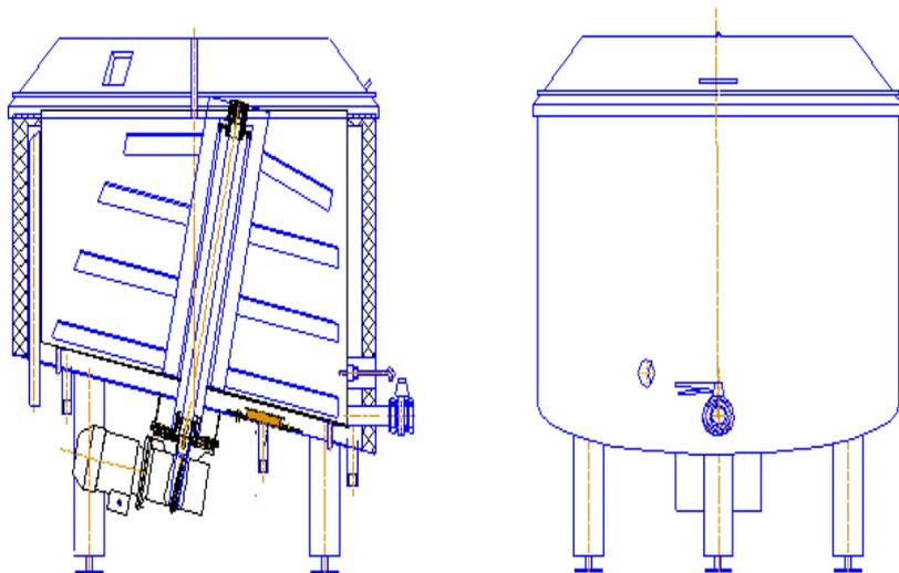
Ванна предназначена для нормализации высокожирных сливок в линиях поточного производства сливочного масла. В ванне может осуществляться нагрев и охлаждение любого молочного продукта в соответствии с технологическим процессом.
